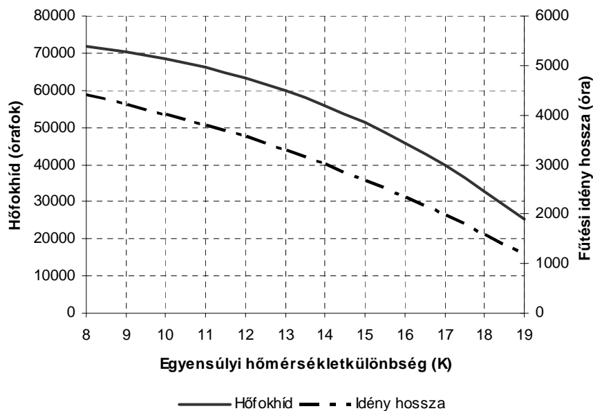
1. ábra: Hőfokhid és fűtési idény hossza 20 °C belső hőmérséklet esetén az egyensúlyi hőmérsékletkülönbség függvényében
